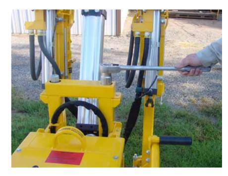
IMPORTANT: BEFORE LEVELING THE DRILL SYSTEMS, CONFIRM THE ANGLE REQUIRED. MANY TIMES THE DRILL SYSTEMS ARE NOT BE "LEVEL WITH THE WORLD", THEY SHOULD BE SET TO DRILL PARALLEL WITH THE TOP OF THE CONCRETE SLAB INTO WHICH YOU ARE DRILLING.
